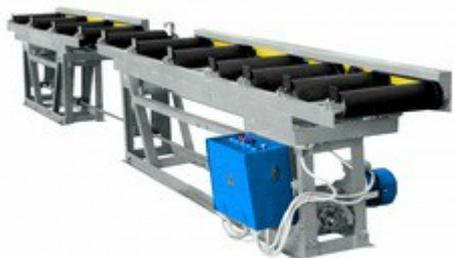
Комплекс модуль-рольгангов подающих приводных МРП - 3 состоит из ведущего рольганга МРП - 3.01 и рольганга удлинительного МРП - 3.02. Комплекс предназначен для облегчения перемещения сортового и фасонного проката при подаче их в рабочую зону пресс-ножниц.
