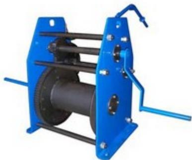
Лебедка ручная однобарабанная модели ЛР – 2,8 предназначена для перемещения грузов при строительных и монтажных работах.
