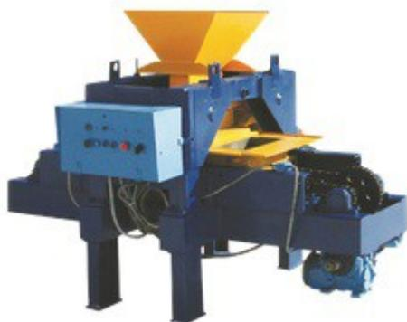
Машина формовочная для изготовления грунтоблоков **КСМ – 10.01** предназначена для изготовления грунтоблоков из разнообразных маловлажных сыпучих материалов.
