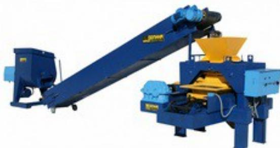
Изготовление строительных блоков на комплексе **КСМ – 10.00** осуществляется в несколько этапов: вначале происходит подготовка смесей методом просеивания на сите, измельчения и дробления на измельчителе, смешивания компонентов в смесителе, затем, при помощи ленточного конвейера, готовая смесь подается в
