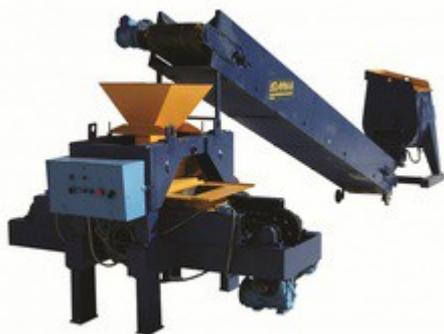
Комплекс для изготовления строительных блоков методом порционного уплотнения **КСМ – 10.00** предназначен для изготовления грунтоблоков из разнообразных маловлажных сыпучих материалов, преимущественно из грунтопесчаных и грунтоцементных мелкозернистых смесей, как на месте строительства, так и в производственных условиях.
