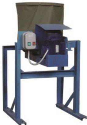
Измельчитель КСМ – 10.06 предназначен для дробления крупных фракций глины или грунта на более мелкие, непосредственно на строительных площадках.
