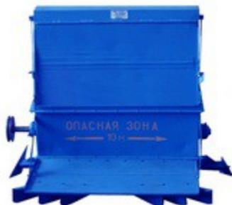
Измельчитель – разбрасыватель соломы модели **ИР – 1** предназначен для измельчения и разбрасывания ее по полю с последующей запашкой, что повышает плодородие почвы и урожайность сельскохозяйственных культур, а также значительно сокращает затраты на подготовку поля к вспашке. Измельчитель – разбрасыватель навешивается в копнитель комбайно «Нива».
