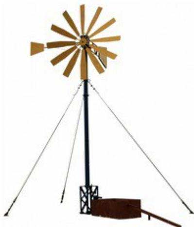
Ветронасосная установка модели **ВНУ – 1** предназначена для механизации подъема воды поршневым глубинным насосом из трубчатых колодцев глубиной до 20 метров в районах, где среднегодовые скорости ветра составляют 5-8 м/с. Использование глубинного насоса в данной установке значительно упрощает процесс эксплуатации, позволяя использовать ее в автономном режиме.
