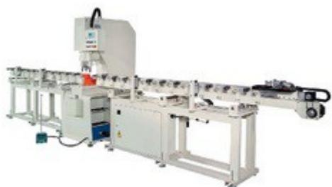
Пресс-ножницы комбинированные гидравлические усилием 1000кН модели **Н – 5630** предназначены для пробивки отверстий, отрезки сортового проката, фасонного (двутавр, швеллер, уголок) и простого профиля (круг, квадрат, полоса), зарубки и выполнения дополнительных операций: гибка, правка, запрессовка, выпрессовка, штамповка в пределах номинального условия.
