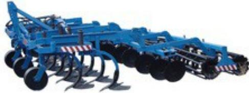
Культиватор **КНК - 6000** предназначен для предпосевной комплексной обработки различных почв без оборота пласта, агрегатируются с трактором К-700 и импортными аналогами.
