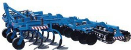
Культиватор навесной комбинированный **КНК – 4000** предназначен для безотвальной предпосевной обработки почвы под большинство сельскохозяйственных культур.
