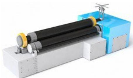
Машина листогибочная трёхвалковая ИК – 2245 предназначена для гибки цилиндрических заготовок из листового проката с максимальными размерами 13x3150 мм с пределом текучести не более 250 МПа (25кг/мм<sup>2</sup>) в холодном состоянии.
