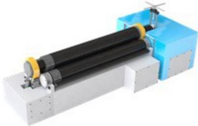
Машина листогибочная трёхвалковая ИК – 2243 предназначена для гибки цилиндрических заготовок из листового проката с максимальными размерами 16х2000 мм с пределом текучести не более 250 МПа (25кг/мм<sup>2</sup>) в холодном состоянии.
