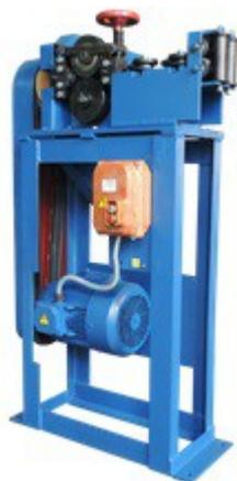
Приспособление для рубки медной проволоки модели **ПРМ – 00 – 001** предназначено для рубки медной и алюминиевой проволоки с  $\sigma_B$  не более 30 кг/мм<sup>2</sup> диаметром до 13мм и стальной с  $\sigma_B$  не более 50 кг/мм<sup>2</sup> диаметром до 10мм.
