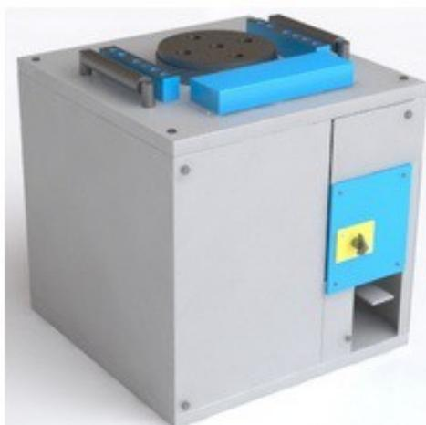
арматуры меняет изначальные параметры заготовки. Происходит это за счет того, что во время сгибания наружные слои металла растягиваются, увеличиваются в размере, а внутренние - сжимаются и уменьшаются в размере. Только слои металла вдоль оси обрабатываемой заготовки сохраняют свои первоначальные размеры после операции. Поэтому при работе со станком для гибки арматуры очень важно - правильно определить размер заготовки. Все расчеты
