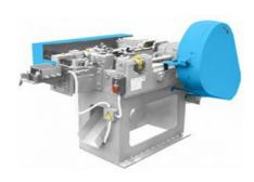
Автомат проволочно-гвоздильный модели АГ - 4116 (гвоздильный станок) предназначен для изготовления гвоздей по ГОСТ 4028-63 и ГОСТ 4034-63 с конической головкой из светлой низкоуглеродистой стальной проволоки по ГОСТ 3282-74. Для тех, кто ищет станок для производства гвоздей, АГ - 4116 является
