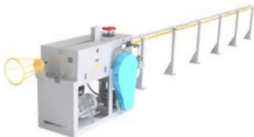
Допускается правка проволоки ГОСТ 6727-80 при изготовлении дополнительного инструмента по требованию заказчика за
