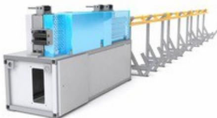
Автомат правильно-отрезной модели **ПРА - 16** с ЧПУ, предназначен для разматывания, правки и мерной резки горячекатаной круглой арматурной стали гладкого профиля диаметром от 4 до 16 мм и периодического профиля диаметром от 4 до 14 мм по ГОСТ 5781-82, поступающей в мотках, в закрытых помещениях. Автомат правильно-отрезной
