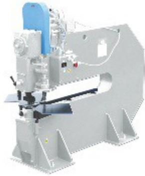
Ножницы высечные модели НК – 4516 предназначены для прямой и фасонной резки листового металла.
