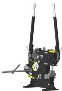
Пресс-ножницы комбинированные с ручным приводом модели **Н – 9818** с четырьмя рабочими зонами позволяют выполнять на одних пресс-ножницах несколько типов операций без предварительной перенастройки ножниц, в любой последовательности и без смены инструмента: отрезку полосы, сортового проката (круг, уголок), пробивку отверстий, пробивку пазов.
