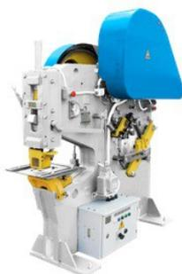
Пресс-ножницы сортовые модели **НГ – 5416** позволяют выполнять на одной машине несколько типов операций без предварительной перенастройки ножниц, в любой последовательности и без смены инструмента, что обеспечивает гибкую и экономичную обработку проката, как в крупном машиностроительном производстве, так и любой ремонтной мастерской.
