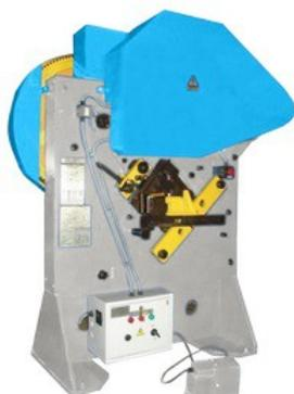
Ножницы для резки металла сортовые модели **НГ – 1433** предназначены для отрезки сортового проката для любого типа производства (единичного, мелкосерийного, серийного, крупносерийного и массового). Ножницы для арматуры сортовые применяются в заготовительных цехах, предприятий металлоконструкций, механических мастерских при эксплуатации в климатических районах с умеренным и холодным климатом, исполнение -УХЛ, сухим и влажным тропическим климатом исполнение О
