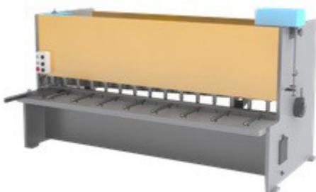
Ножницы гидравлические гильотинные с наклонным ножом для листа 12x3150мм модели **НГ – 3422** предназначены для холодной резки листового и полосового металла. Резка может производиться как по разметке, так и с применением заднего и бокового упора.
