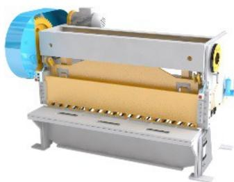
Ножницы с наклонным ножом (гильотина) относится к самому популярному среди промышленных производителей металлических изделий оборудованию для резки металла. Станок незаменим на предприятиях металлоконструкций, машиностроительных предприятия, ремонтных и других заводах.
