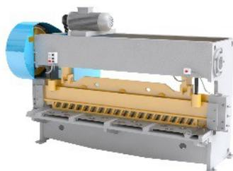
Ножницы гильотинные (листовые кривошипные) с наклонным ножом для листа 16x2500 мм модели **НЛ – 3424** предназначены для холодной резки листового металла, уголка и круга. Резка может производиться как по разметке, так и с применением заднего и бокового упора.
