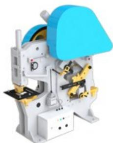
Пресс-ножницы **НГ – 5222** комбинированные (универсальные) (снятые в 1957 г. с производства мод. Н – 5222, пресс-ножницы НВ – 5222) для полосы 16 x 150 мм служат для отрезки полосового, сортового и фасонного проката и пробивки отверстий в листовом, полосовом и фасонном прокате.
